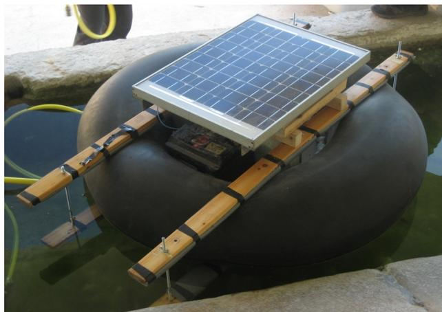
El prototipo consta de un elemento flotante sobre el que se ha instalado una motobomba para la extracción del agua marina a través de una manguera que recoge el agua para enviarla a otra que desemboca en el depósito donde se almacenará el agua de mar extraída. La energía necesaria para el funcionamiento de la motobomba es adquirida por una plaquita solar.
